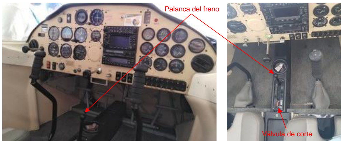
Figura 2. Fotografía general de la cabina (izquierda) y de detalle (derecha) sobre las que se ha señalado la posición de la palanca de accionamiento del freno y de la válvula de corte (freno de aparcamiento)
